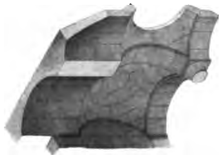
Fig. 8. — Voûte sphérique appareillée (Jérusalem, porte au Haram-ech-Chérif, d'après Choisy).
